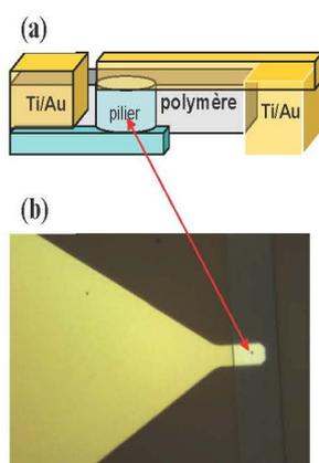
Fig. 1 : (a) Schéma de la fabrication de jonctions nanométriques. La jonction tunnel magnétique est gravée en forme de pilier nanométrique
